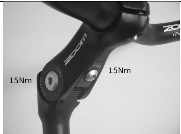
Afbeelding 9 : Helling van de stuurpen, draaimomenten
