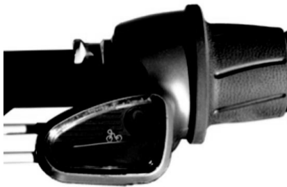
Abbildung 13: In dieser Position („full overdrive“) ist die Gangübersetzung hoch. Wie auf dem Piktogramm zu sehen, wird diese Position für ebenes Gelände oder bei Abfahrten benutzt.
