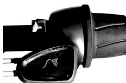
Abbildung 14: In dieser Position ist die Gangübersetzung niedrig. Diese Position wird für Steigungen genutzt, und wenn es schwierig ist, in die Pedale zu treten und ein vernünftiges Tempo aufrechtzuerhalten.
